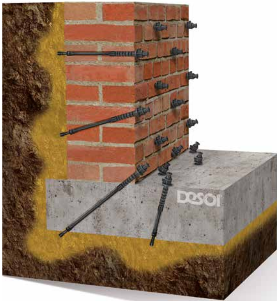
Schleierinjektion | Curtain injection
